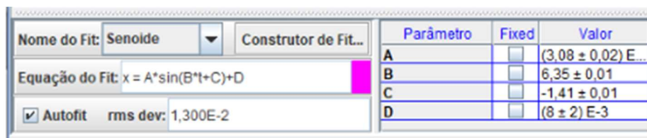
Figura 06: ajuste trigonometria obtido pelo Tracker e seus coeficientes equivalentes da eq 1
