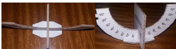
Figura 4: Arco Latitudinal posicionado, encaixado e colado perpendicularmente à Base. Nesta junção as Travas desempenham papel de aumentar a estabilidade do equipamento e garantir maior precisão.
